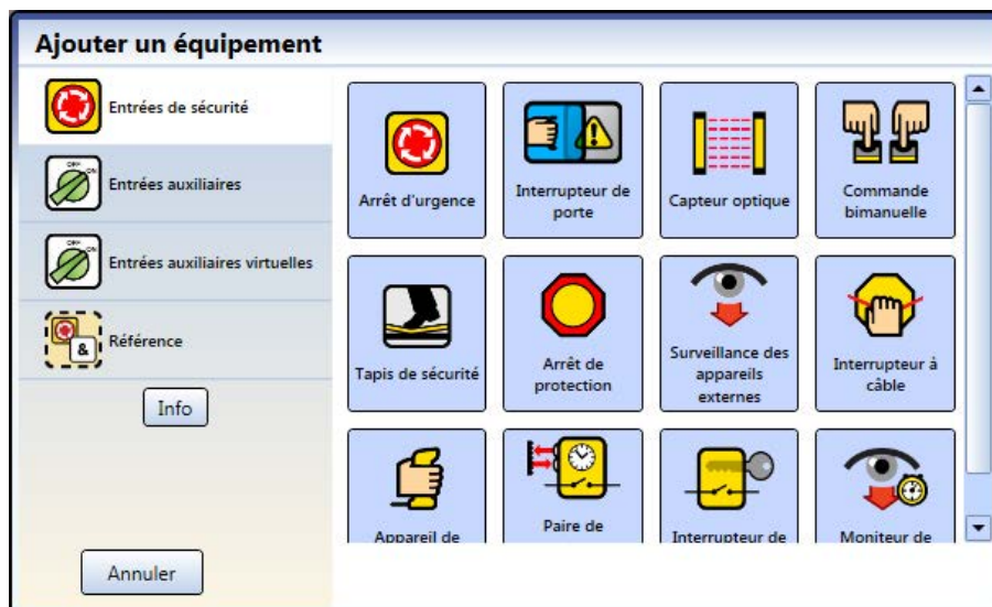
Illustration 50. SC10-2 : Ajout d'entrées à partir de la vue Équipement (la sortie d'état physique ne peut être ajoutée qu'à partir de cette vue)
