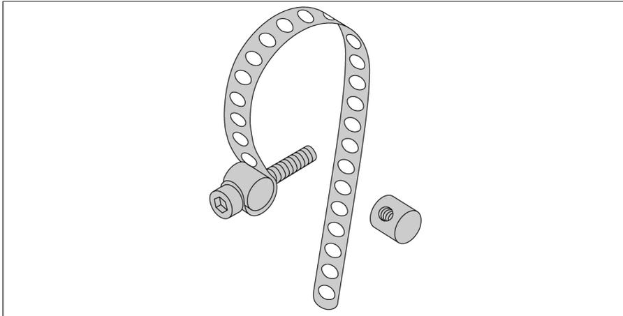
монтажный набор состоит из: ремень, диаметры цилиндров 80... 25 мм; (материал: нержавеющая сталь), 2 задвижки (материал: бронза) цилиндрический болт М3 х 20; DIN 912-A20
