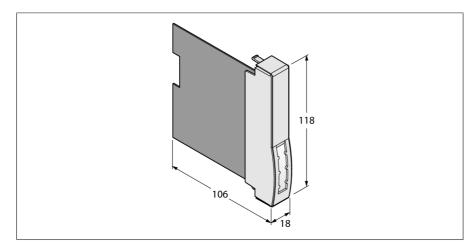
Модуль-заглушка для неиспользованных слотов в стойке
