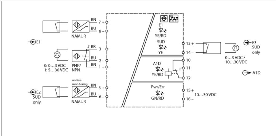
Le convertisseur de mesure de fréquence IM12-FI01-1SF-1R-0/24VDC/CC transmet les signaux de fréquence jusqu'à 20000 Hz séparés galvaniquement. L'appareil permet de surveiller des valeurs limites. L'appareil est destiné à une utilisation en zone 2.
