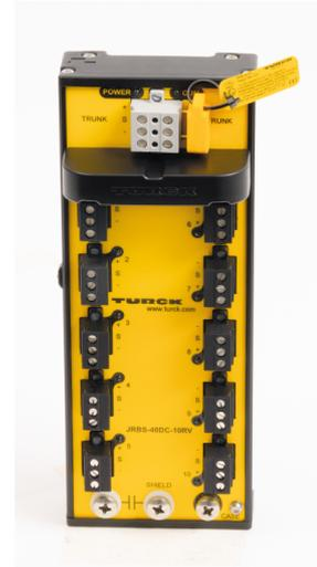
Le répartiteur est conçu pour les systèmes de bus de terrain suivant IEC 61158-2, c'est-à-dire tant pour le FOUNDATION™ fieldbus que pour le PROFIBUS PA. En utilisant un appareil d'alimentation approprié, le répartiteur de bus de terrain peut aussi être utilisé pour les applications Ex.
