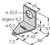
bride de fixation, noir PBT, pour les détecteurs à filetage 30 mm, orientable
