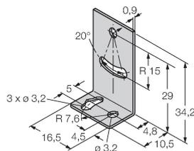
équerre de montage, matériau VA 1.4401, pour le détecteur photoélectrique du format Q12
