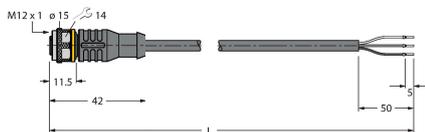
Câble de raccordement, connecteur femelle M12, droit, 3 broches, longueur de câble : 2 m, matériau de la gaine : PVC, noir ; homologation cULus
