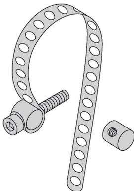
Montaje en cilindros redondos; diámetro del cilindro de 80...200 mm; material: metal A2 1.4301 (AISI 304), dos pernos de fijación (material: metal CuZn, como alternativa metal A2 1.4301 / AISI 304) tornillo del cilindro M3 x 20 (DIN 912-A20)
