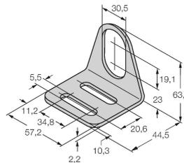
Soporte de montaje para sensores de tubo roscado; material: acero inoxidable A2 1.4301 (AISI 304)
