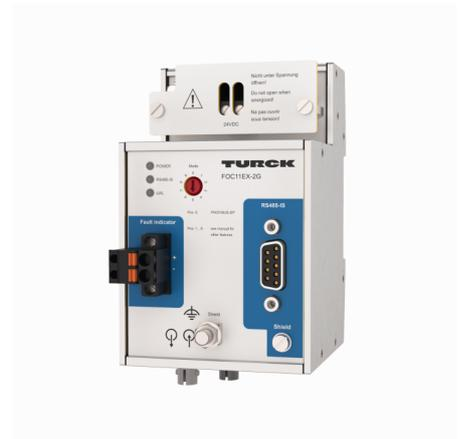
El convertidor de medios de fibra óptica FOC11... convierte las señales RS485-IS, p. ej., de PROFIBUS-DP o Modbus RTU de los cables de cobre en señales ópticas y viceversa. Por lo tanto, las señales de bus, intrínsecamente seguras, se pueden transmitir desde la Zona 1 sin potencial ni interferencia.
