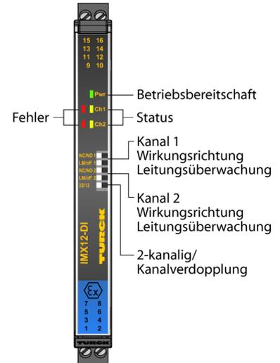
An den Trennschaltverstärker IMX12-DI01-2S-2PP-0/24VDC können Sensoren nach EN 60947-5-6 (NAMUR) oder potenziellfreie Kontakte angeschlossen werden. Das Gerät ist zweikanalig ausgelegt, kann aber auch als Splitter verwendet werden. Das Gerät ist mit eigensicheren Eingangskreisen ausgestattet und kann in Zone 2 montiert werden. Der Ausgangskreis ist mit 2 Push/Pull-Ausgängen mit hoher Grenzfrequenz (15 kHz) ausgestattet. Das Gerät erfüllt die Anforderungen der NE21.
