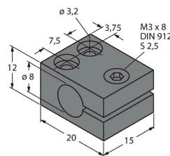
Befestigungsschelle für Gewinderohrsensoren; Werkstoff Montageblock: Aluminium, eloxiert
