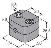
Befestigungsschelle für Glatt- und Gewinderohrsensoren; Werkstoff: Polypropylen
