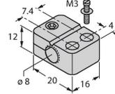
Befestigungsschelle für Gewinderohrsensoren, mit Festanschlag; Werkstoff: PA6
