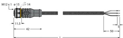
Anschlussleitung, M12-Kupplung, gerade, 3-polig, Leitungslänge: 2 m, Schutzmantelmaterial: Aramidfasern, gelb; Temperaturspitze: 200 °C
