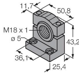
Montagehalterung, PBT-schwarz, für Sensoren mit 18-mm-Gewinde, ausrichtbar
