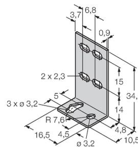
Montagewinkel; Werkstoff VA 1.4401, für Optosensor Bauform Q12
