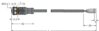
Anschlussleitung, M12-Kupplung, gerade, 4-polig, Leitungslänge: 2 m, Mantelmaterial: PUR, schwarz; cULus-Zulassung
