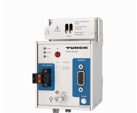
Der LWL-Medienkonverter FOC11... wandelt RS485-IS Signale, z. B. von PROFIBUS-DP oder Modbus RTU, von Kupferleitungen auf Lichtwellenleiter und vice versa um. Damit lassen sich eigensicher Bussignale aus der Zone 1, potenzialfrei und störungssicher über große Entfernungen übertragen.
