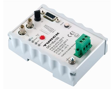
光电耦合器OC11Ex/3G.2把PROFIBUS-DP 信号转换成光信号。因此，总线信号可以长距离从安全区域传输到防爆区域，而不会产生潜在风险或干扰。当使用光缆时，OM1 (62.5/125- $\mu\text{m}$ )光缆的最大传输距离为2500 m，OM2 (50/125- $\mu\text{m}$ )光缆的最大传输距离为1500 m。
