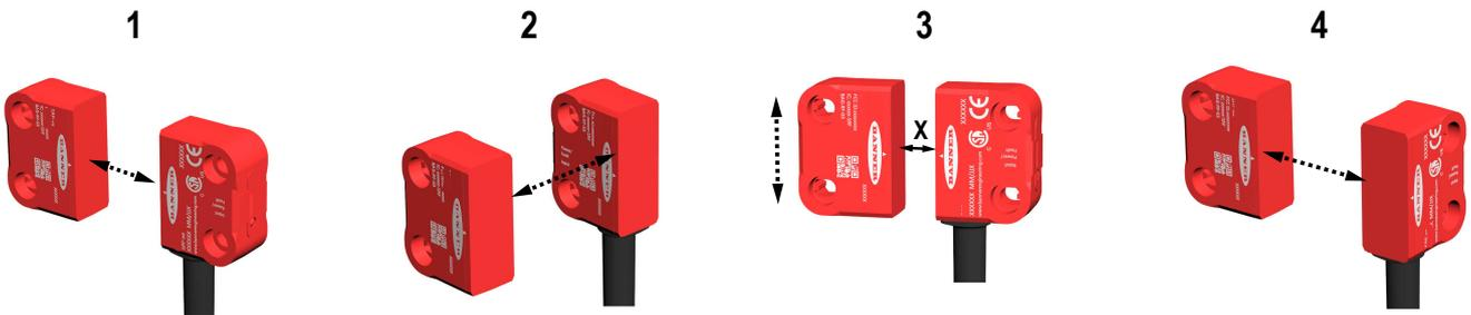
Les distances de commutation du sens d'actionnement standard 1 sont indiquées. Les distances spécifiées concernent un capteur fonctionnant avec les actionneurs standard (SI-RF-A et SI-RF-A2).
