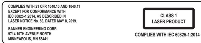
**Longueur d'onde du laser :** 655 nm    **Sortie :** < 0,39 mW
